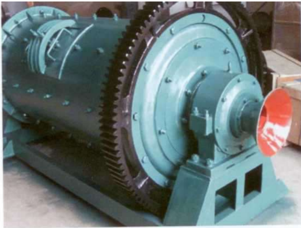
Для измельчения руды используют шаровые мельницы
